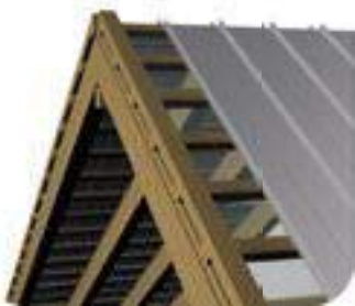
Sch. 21 Montage des planches de rive
