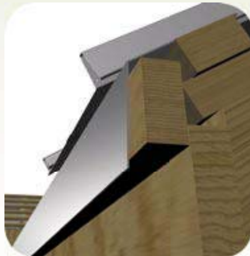
Sch. 9 Les panneaux dépassent de l'avant-toit de 4 à 5 cm
