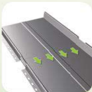
Sch. 18 Appariement des panneaux- si cela est nécessaire, il faut courber le joint
