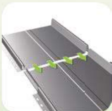
Sch. 17 Découpe du joint de chaque côté du panneau
