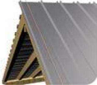
Sch. 22 Pose du dernier panneau
