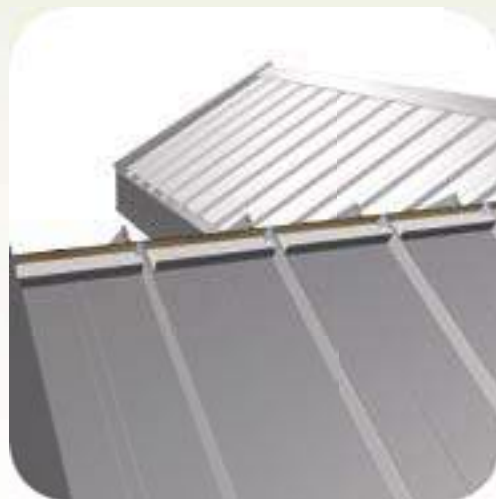
Sch. 28 Les faîtages sont fixés sur des barres de fixation spéciales
