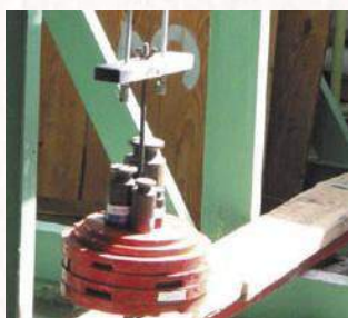
Poste d'essai dans Instytut Techniki Budowlanej [Institut de la Technique de Construction] Ecartement des crochets - 1180 mm charge - 750 N
