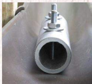
Poste d'essai dans Instytut Techniki Budowlanej [Institut de la Technique de Construction] Ecartement des crochets - 1180 mm charge - 750 N
